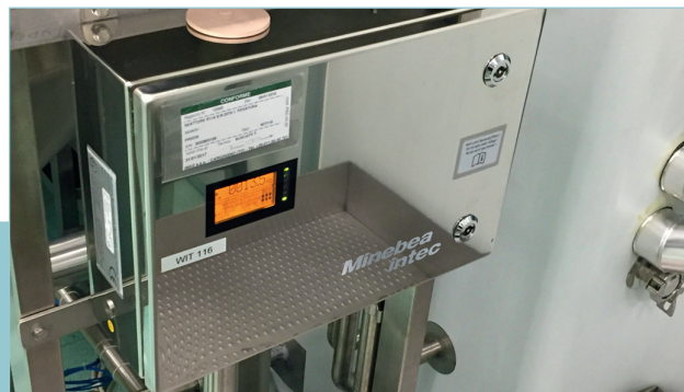
Le celle di carico e l'elettronica di pesatura di Minebea Intec assicurano una pesatura affidabile di serbatoi di processo
