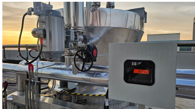
Integrati nel sistema DCS, gli indicatori di peso X2 consentono un controllo automatizzato del processo di carica e scarica.
