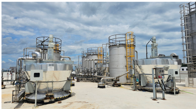
Le celle di carico PR 6212 forniscono una pesatura affidabile in ambienti ad alta temperatura, umidi e corrosivi.
