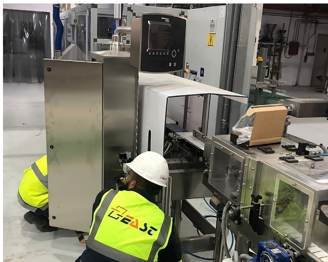
EAST公司进行Flexus®检重秤安装，集成迅速且特别节省空间。
